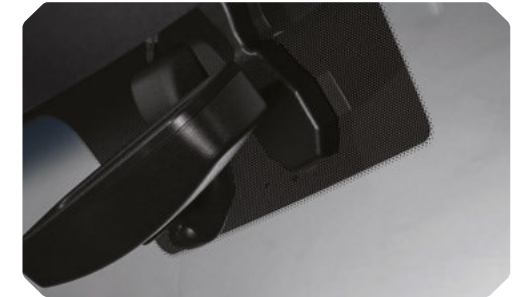
Caméra avant avec capteurs de pluie et de luminosité
