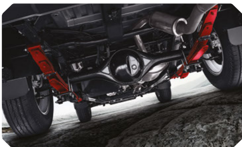
Suspension arrière renforcée avec ressorts à lames
