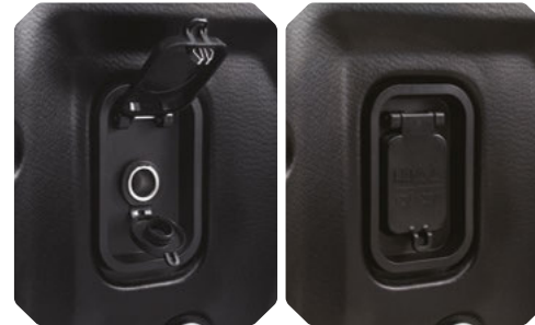
Prise électrique dans la benne
