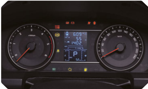
Panneau d'instruments avec l'ordinateur de bord et écran TFT 3,5"
