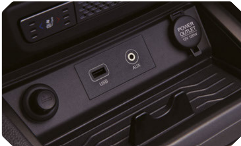
Port USB, AUX et prise de courant 12V
