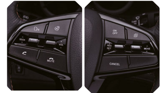
Commandes du système d'infodivertissement et du régulateur de vitesse au volant
