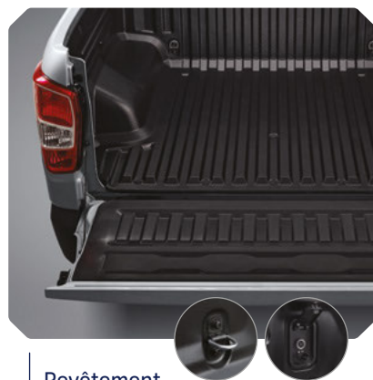
Revêtement de benne ouvert, avec anneaux de fixation et prise électrique
