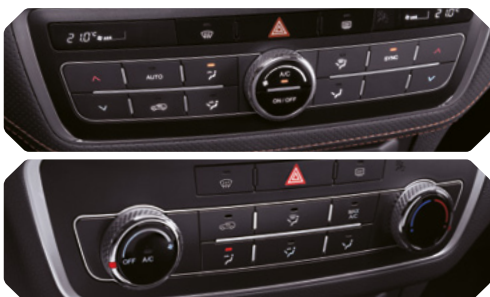
Climatisation bi-zone automatique/ Climatisation manuelle
