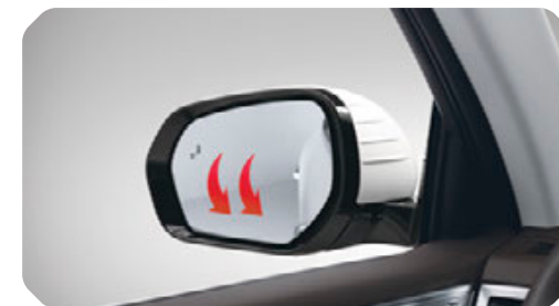
Rétroviseurs extérieurs automatiques, orientés vers le bas pendant la marche arrière
